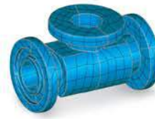
② ポリゴン編集ツールでパッチング、穴埋め、スムージング
