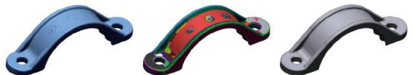
① 3Dスキャンしたメッシュデータ の取り込みと修正 ② スキャンデータから寸法を読み取りながらのリバースモデリング ③ リバース後CADデータに変換し、各種CADソフトへ橋渡し
