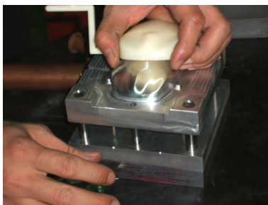
簡易型（カセット型）で短納期で成形品を作成する技術（切削RM）が強み。
